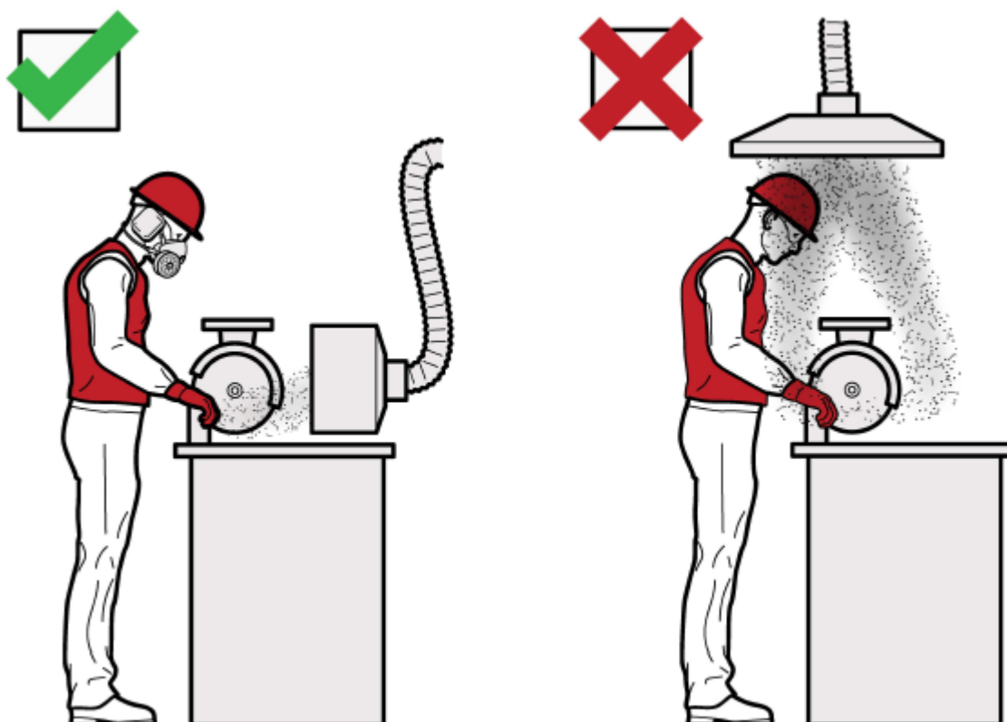
圖七 使用局部通風排氣系統的例子
